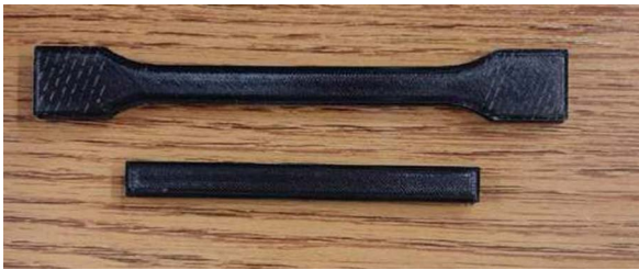
Rysunek 13. Próbkki do badań wytrzymałościowych – filament bazowy PET [2]
