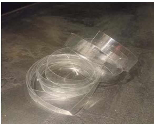
Rysunek 4. Materiał wejściowy do wytwarzania ekofilamentu PET – wycięte fragmenty/paski ze zużytych butelek po napojach [2]
